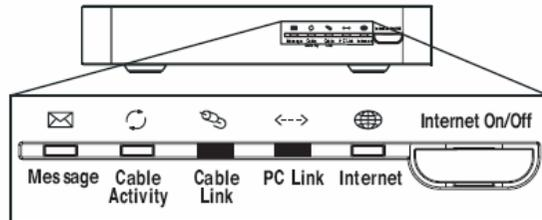
Das Thomson Modem verfügt über 5 Leuchtdioden, welche den aktuellen Betriebsstatus anzeigen.
